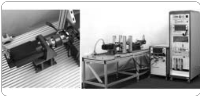
그림 17. 전기 조향 시스템을 테스트하기 위한 HIL 시뮬레이터의 예. 테스트 벤치에서 조향 시스템에 가해지는 기계적인 로드들은 차량에 있는 것과 동일하다.
